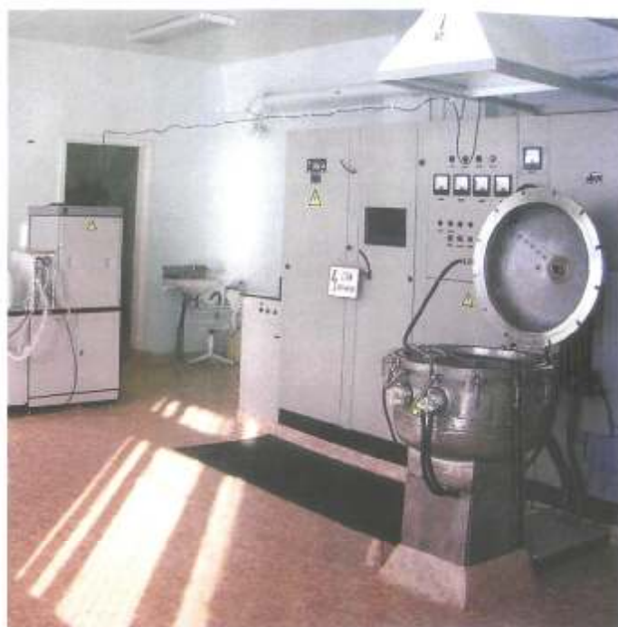
Рисунок 2. Вакуумно-компрессионная плавильная индукционно-шлаковая электропечь
