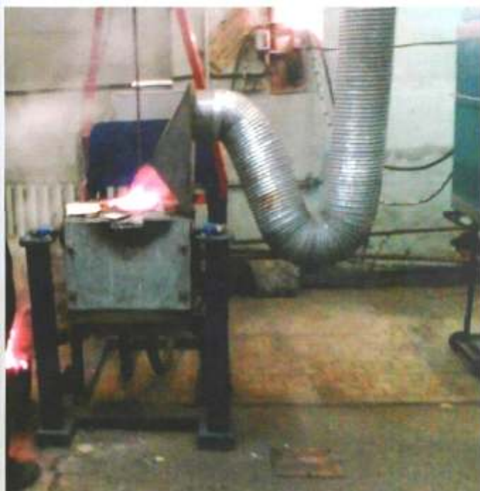
Рисунок 1. Индукционная плавильная электропечь емкостью 30 кг
